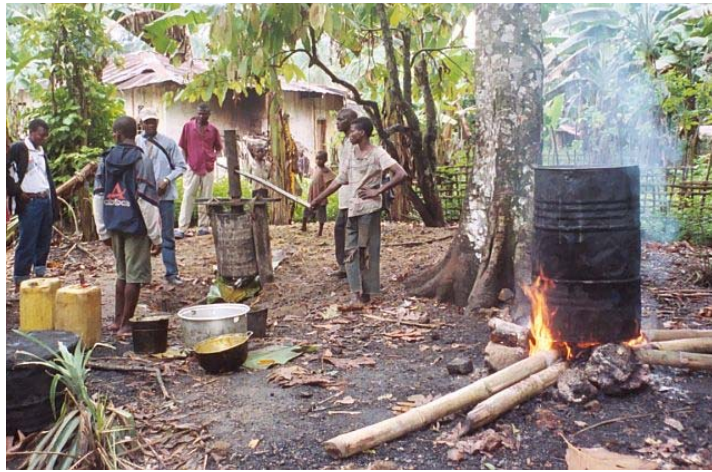
Figure 2. Opération de traitement de l'huile de palme ; les noix de palme sont en train de bouillir dans un fût à droite, puis elles sont pressées et conservées dans des bidons en plastique jaune de 25 litres. (Photo de Rick Alexander)
