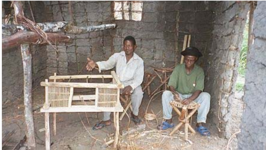
Figure 9. Deux villageois fabriquant des meubles à l'aide d'un couteau et d'un marteau, village de Eden-Mobzeno. (Photo de Rick Alexander)
