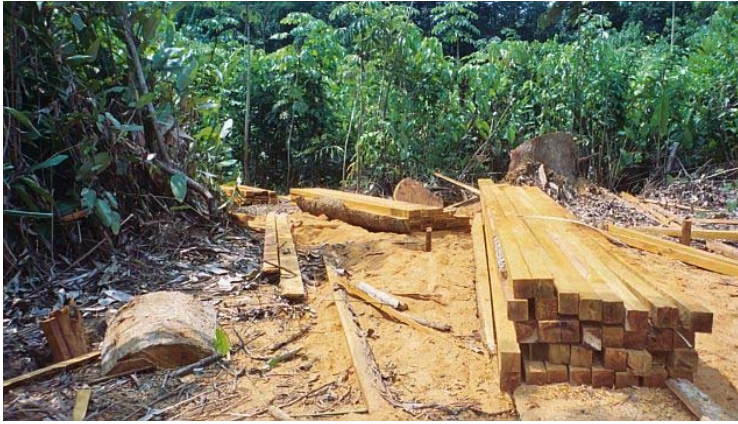
Figure 7. Planches coupées par une scie électrique mobile, 7x7 cm x 5,2 m. (Photo de Rick Alexander)
