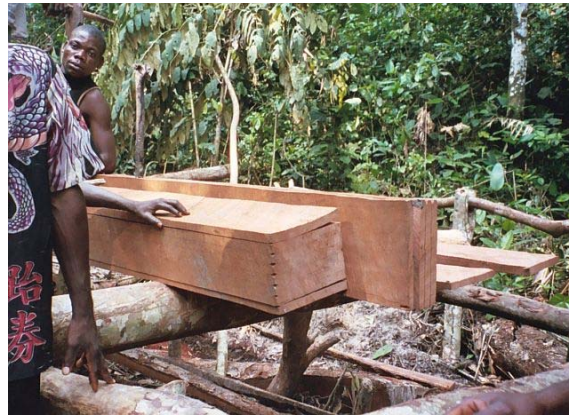
Figure 4. Une grume équarrie est marquée et crantée pour guider le sciage des planches. (Photo by Rick Alexander)
